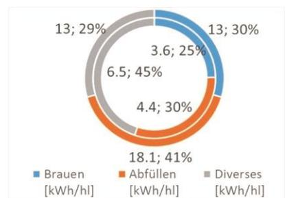
Auf dem äusseren Kreis ist der thermische und im inneren Kreis der elektrische Energieverbrauch pro hl Bier im Jahr 2014 ersichtlich. Die energieintensivsten Prozesse sind das Bierbrauen im Sudhaus sowie das Abfüllen des Bieres im Flaschenkeller.
